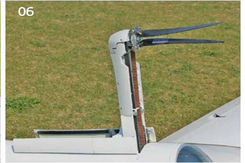
01-08 | Die Sequenz zeigt sehr gut die Arbeitsweise der Mechanik. Hier ist auch die im Text erwähnte Variante mit vier Klappen zu sehen, bei der der hintere Teil im Kraftflug verschlossen wird
