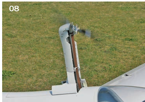
01-08 | Die Sequenz zeigt sehr gut die Arbeitsweise der Mechanik. Hier ist auch die im Text erwähnte Variante mit vier Klappen zu sehen, bei der der hintere Teil im Kraftflug verschlossen wird
